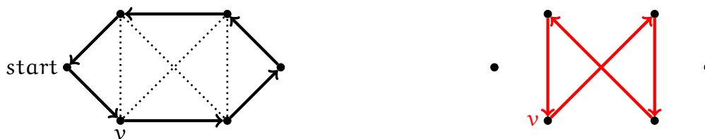
Abbildung 1.12: Der erste (schwarz) und zweite (rot) Weg des schnellen Läufers S. Nach dem ersten Weg bleibt der schnelle Läufer stecken. Danach bewegt sich der langsame Läufer entlang der ersten Kante nach v und entdeckt, dass es von dort noch unbenutzte Kanten gibt. Dann läuft der schnelle Läufer von v aus die rote Tour ab und vereinigt die beiden. Anschliessend läuft der langsame Läufer die restliche Tour ab (erst den roten Teil, dann den restlichen schwarzen), entdeckt aber keine weitere ausgehenden Kanten.
